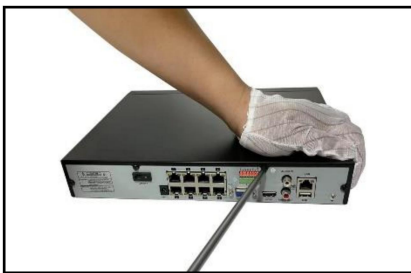
Remover la Cubierta
